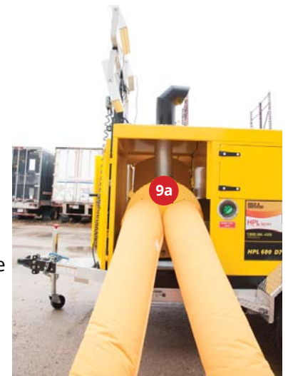
Heat Outlet Door 2 x 12" Outlets
