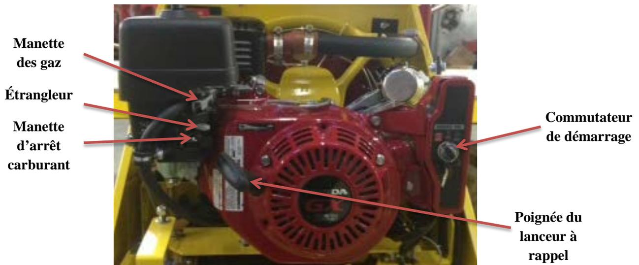
**Figure 4-3. Commandes du moteur**
