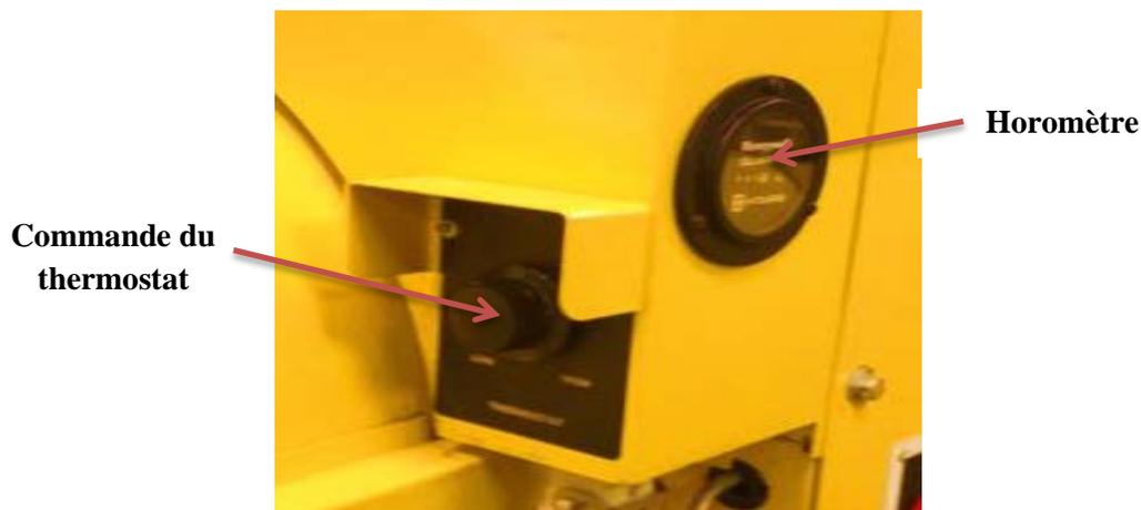
Figure 4-6. Commande du thermostat
